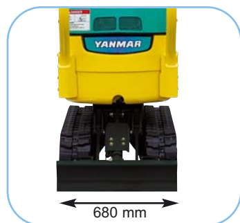
Zasunutý podvozek umožňující snazší manévrování přes překážky
